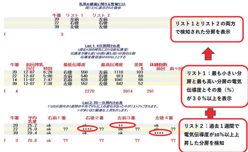
図1 電気伝導度センサーによる乳房炎の検知
